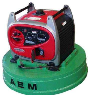
発電機はゴム板の内側に置いたままです。この状態で発電機のメンテナンス作業が出来ます。発電機の再設置はリフマグ側のゴム板の内側にはめ込んでください。ゴム板の上に乗らないように設置して下さい。(カバーが正常に組付かない)
