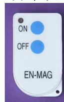
本体側の電源SWのみONでテストSWはOFFでリモコン操作となります。(リモコンは防水ではありません) ON側1回押すとリフマグが作動します。OFF側を1回押すとリフマグが停止します。送信機が小型の為、紐を付けて紛失しない様に管理して下さい。
