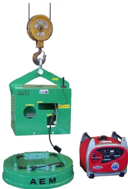
発電機の詳細点検はこの様に器機を分けて行って下さい。リフマグの上にエンジンオイルや燃料を漏らさないで下さい。エンジンオイルは10W-30又は10W-40を0.6ℓで燃料はレギュラーガソリンmax-6ℓです。詳しくは発電機の取説を参考にして下さい。
