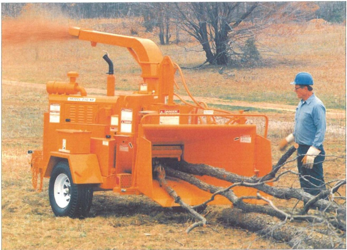
ディーゼルエンジン駆動・ガソリンエンジン駆動・トラクタPTO駆動・電動モーター駆動あります
