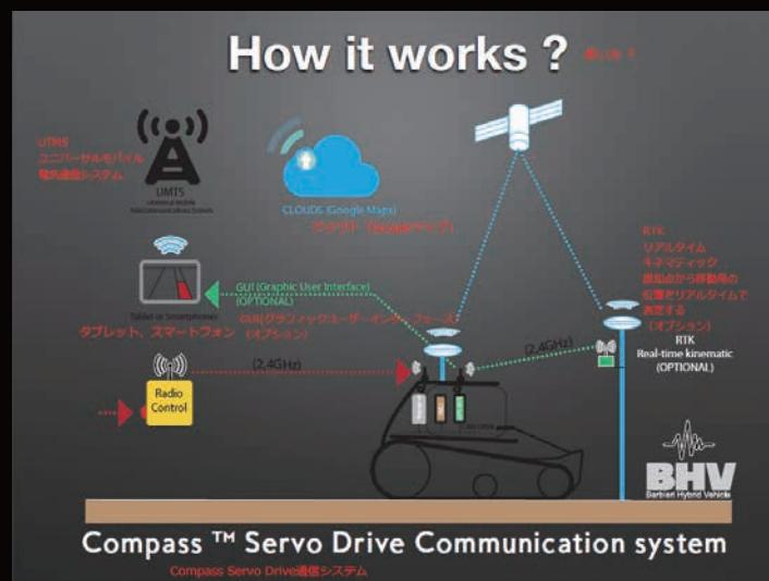
オプションのGPS自動ドライブシステムを搭載すると、自動制御運転が可能になります。専用アプリをインストールし、スマホやタブレットで作業範囲の設定等を行います。
