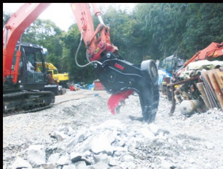
220V、24Vマグネット付 コンクリート小割圧碎機
