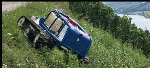
最大200m離れた場所から遠隔操作することにより、オペレーターは「危険な斜面」「エンジンの騒音」「排気ガス」「ほこり」から安全な距離を保ち、一日中快適に作業することができます。これにより、オペレーターが「ダニ」や「蜂の巣」と接触することも少なくなります。
