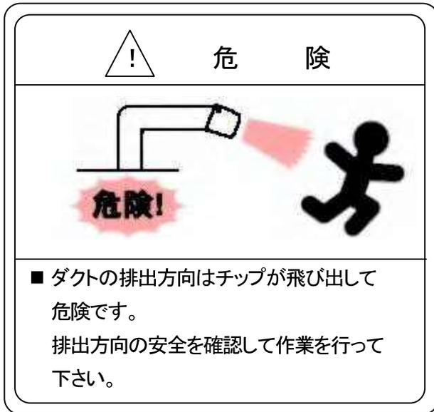
1. 粉碎された材料は、排出ダクトより勢いよく排出されますので事故につながる可能性があります。作業に入る前に、排出ダクトの排出方向を定め、作業中に排出ダクトが動かないようにダクト固定ハンドルをしっかり締めてから作業を開始して下さい。
