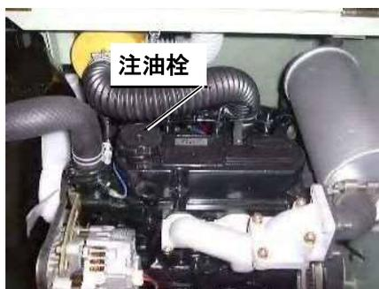
すだけでなく故障の原因となります。定期的に古いオイルを抜き取り、新しいオイルを規定量給油して下さい。
