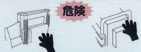
■ フィードボックス・送りローラ取付部に直接触れないようにして下さい。
