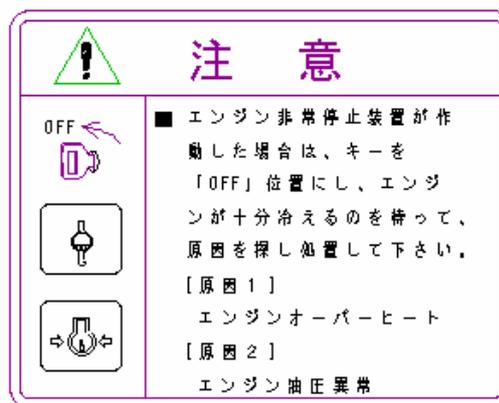
エンジンが異常を検知し自動停止し、エンジン警告灯が点灯します。(ホッパ部、キースイッチ横)
