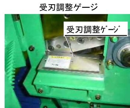
5. 2枚のチップナーナイフのうち、受刃とのすきまの狭い方を基準にしてアジャストボルトを動かし、ロータを回転させながらチップナーナイフと受刃のすき間が均等に、なおかつすき間と調整ゲージの板厚が等しくなるように調整します。
