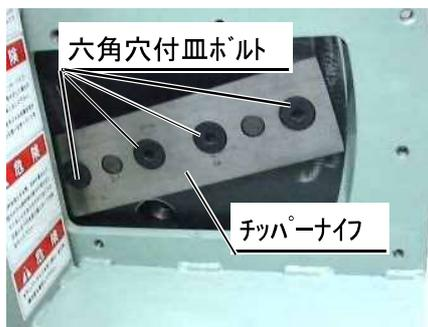
(4本)を固定し、裏側にあるナットを緩め六角穴付皿ボルト(4本)を外します。
