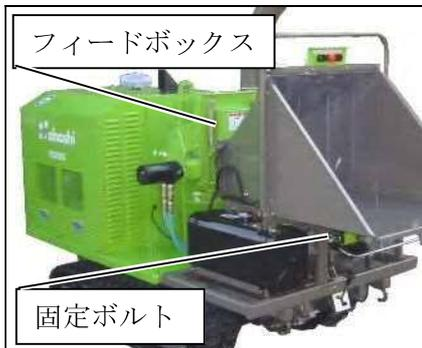
2. 受刃を下側から固定している受刃固定ボルト（2本）を外します。
