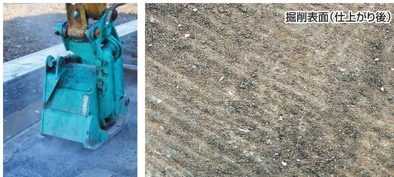
切削深さを0~100mmまで無段階で自由に設定できます。切削部分を本体が覆っているため、安全・快適に作業を行えます。切削ハツリ作業に最も適した配置により、効率のよい切削ができます。コンクリート切削作業にも専用切削ビットの交換で対応が可能です。
